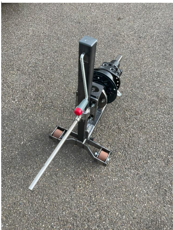
Abbildung 30: Radmotoren-Heber Ansicht hinten
