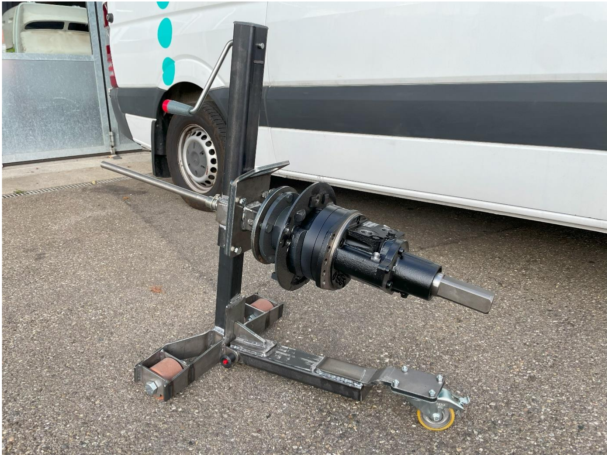
Abbildung 33: Radmotoren-Heber komplett zusammengebaut
