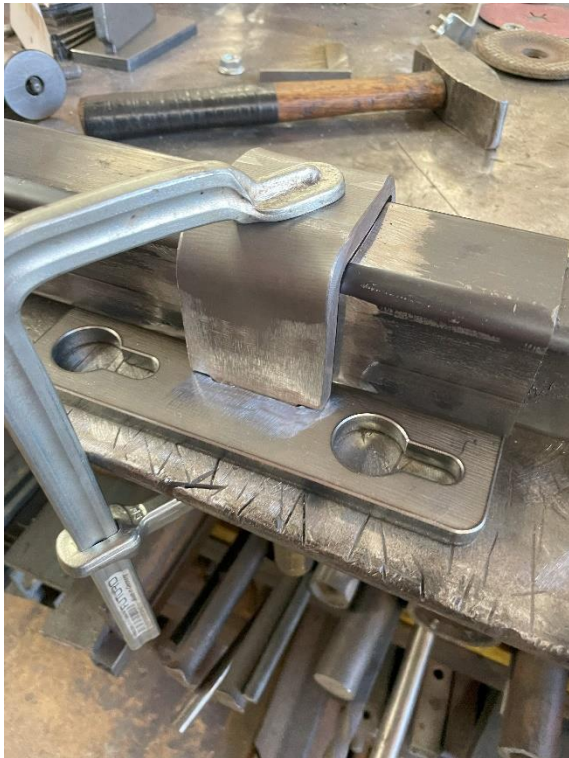
Abbildung 26: Blechlasche Flanschplatte hinten
