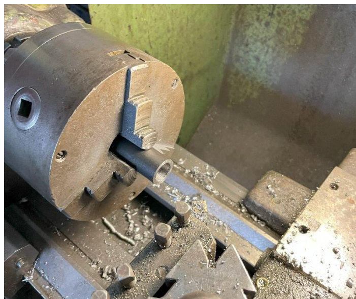
Abbildung 20: Führungsrohr in Drehbank
