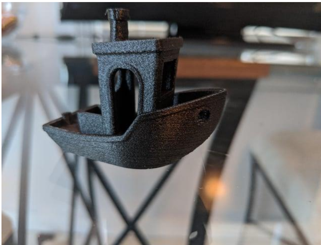
ABBILDUNG 12: EIN "BENCHY" AUS CARBON-NYLON MIT DER TYPISCHEN MATTEN OBERFLÄCHE
