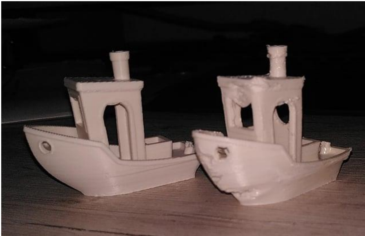
ABBILDUNG 9: EIN "BENCHY" AUS ASA. ZWEI VERSCHIEDENE DRUCK VERSUCHE MIT VERSCHIEDENEN EINSTELLUNGEN.
