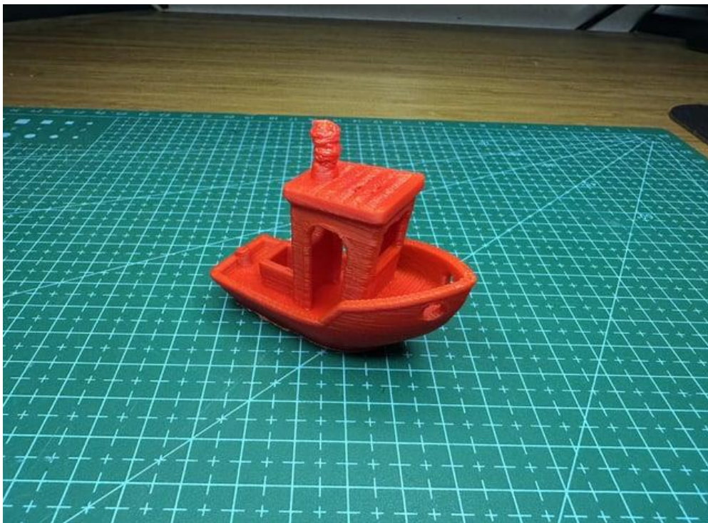
ABBILDUNG 8: EIN "BENCHY" AUS ABS. DIE QUALITÄT NIMMT EIN WENIG AB, KANN ABER MIT EINSTELLUNGEN VERBESSERT WERDEN.
