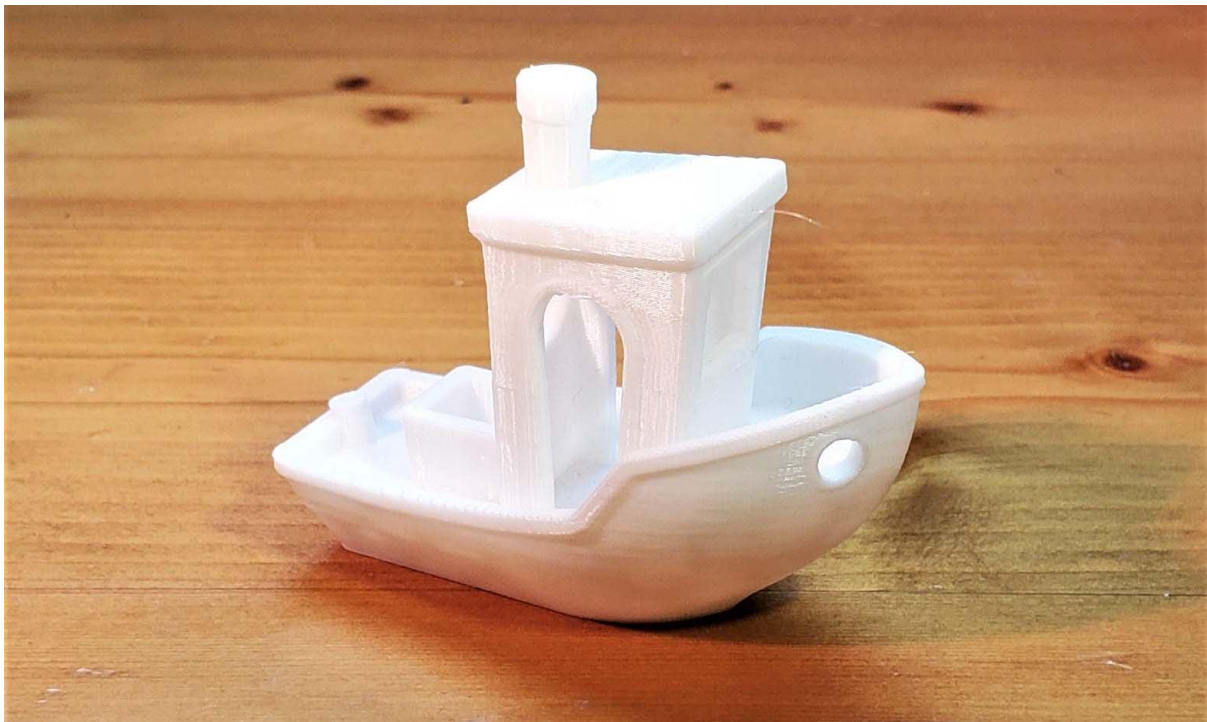
ABBILDUNG 11: EIN "BENCHY" AUS NYLON. WIE MAN SEHEN KANN MIT DEN RICHTIGEN EINSTELLUNGEN, KANN ALSO GUTE QUALITÄT ERREICHT WERDEN
