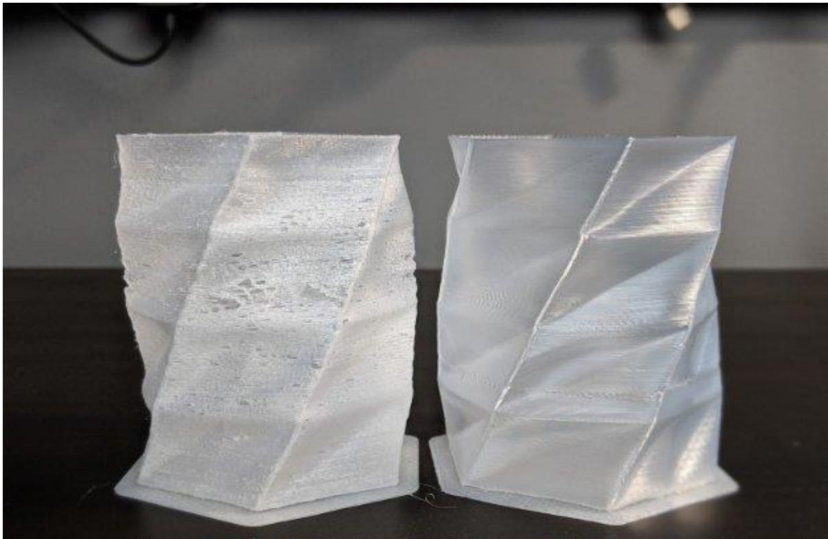
ABBILDUNG 20: HIER IST DEUTLICH ZU SEHEN, WIE NICHT NUR DIE OPTISCHE, SONDERN AUCH DIE STRUKTURELLE QUALITÄT NACHLÄSST, WENN DAS FILAMENT NICHT KORREKT GETROCKNET WIRD.
