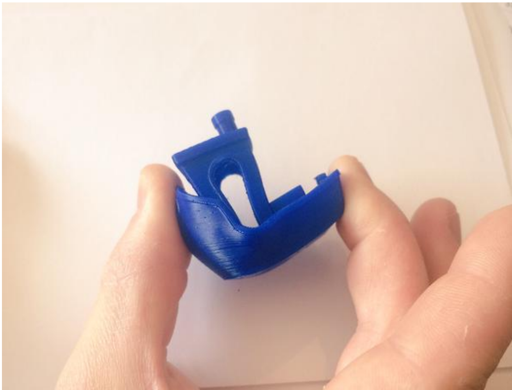
ABBILDUNG 10: EIN "BENCHY" AUS TPU. DER DRUCK, FLEXIBEL UND QUALITÄT ERSTAUNLICH GUT
