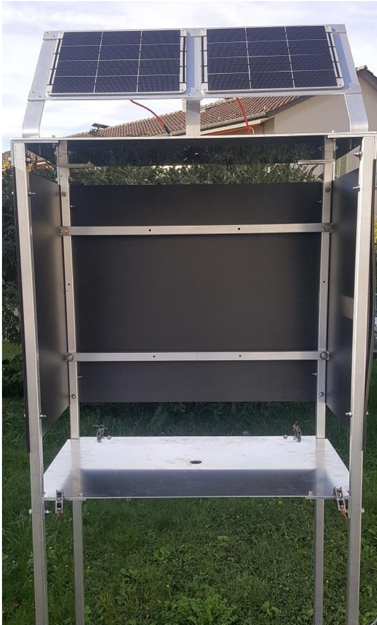
Abbildung 98: Elektronikboxhalterung mit Solarpanel Halterung
