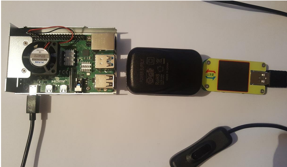
Abbildung 39: Messaufbau mit Raspberry Pi 4
