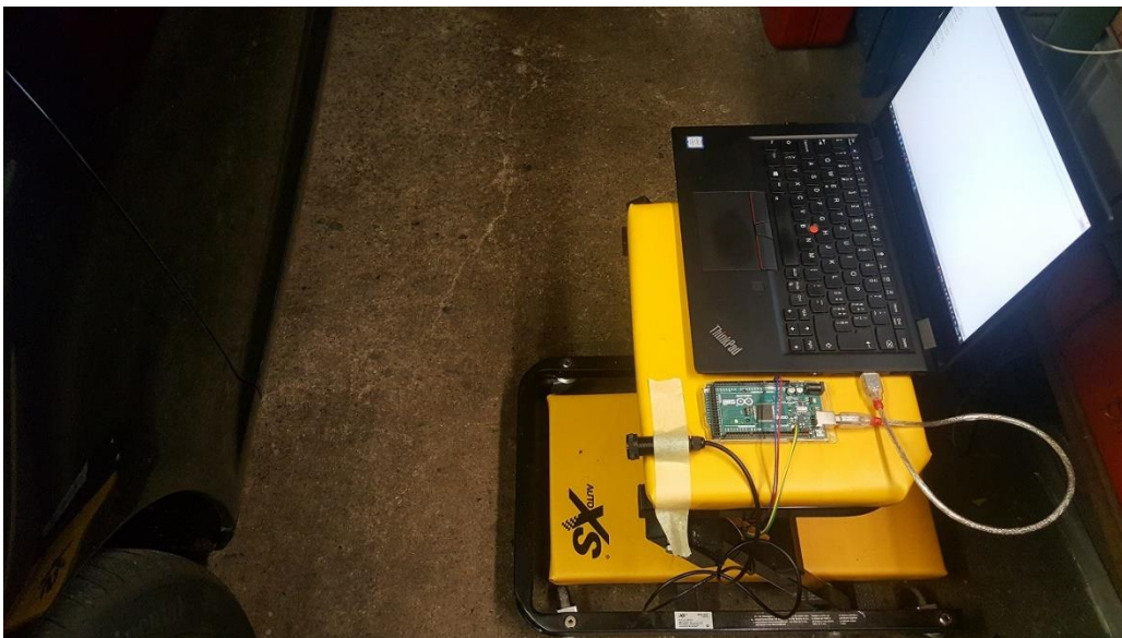
Abbildung 8: Messaufbau mit Arduino und Sensor
