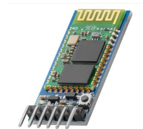
Abbildung 29: Bluetooth-Sender HC-05 (Quelle: https://www.amazon.de )
