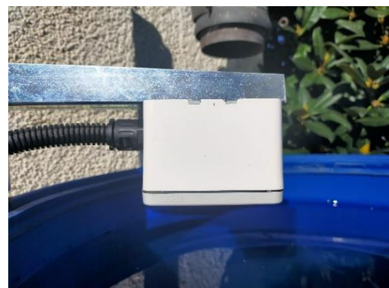
Abbildung 21: wasserdichte Dose für den Ultraschallsensor
