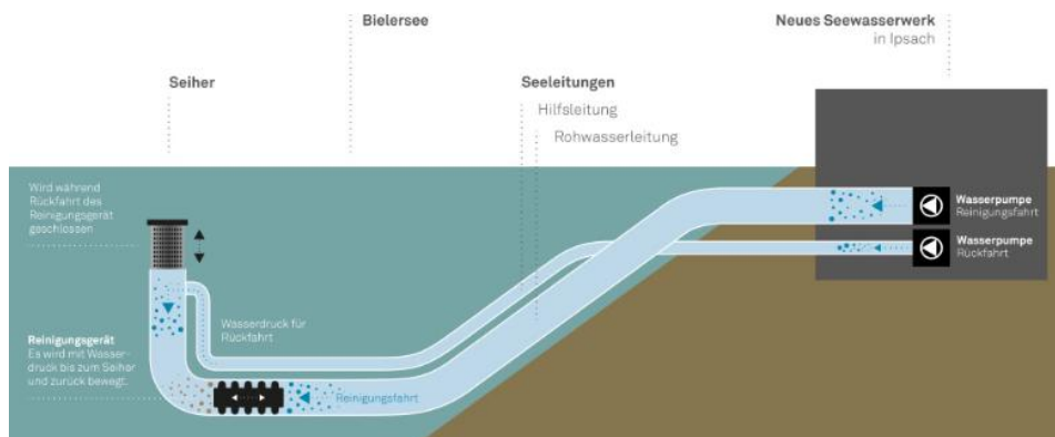
Abbildung 8: Schema eines Molchverfahren. (Energie Service Biel (ESB), 2024)
