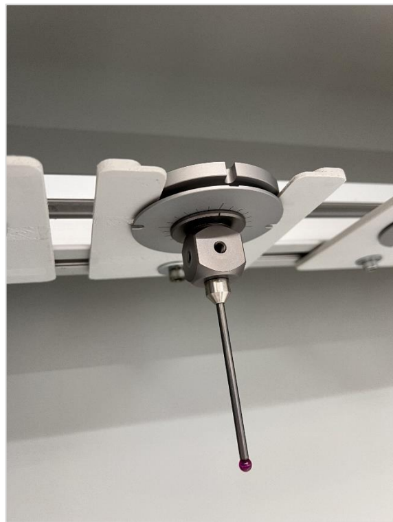
Abbildung 4: Haltevorrichtung für Messtaster Zeiss
