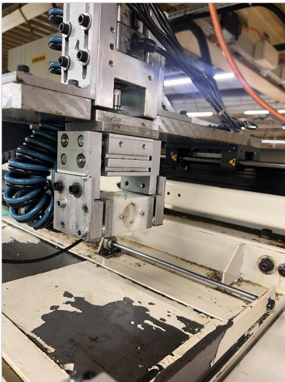
Abbildung 14: Greifer Teilehandling Okuma
