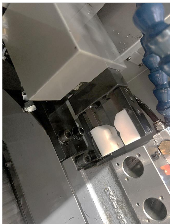
Abbildung 10: Greifer Teilehandling Citizen
