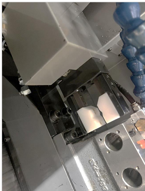
Abbildung 15: Greifer Teilehandling Citizen
