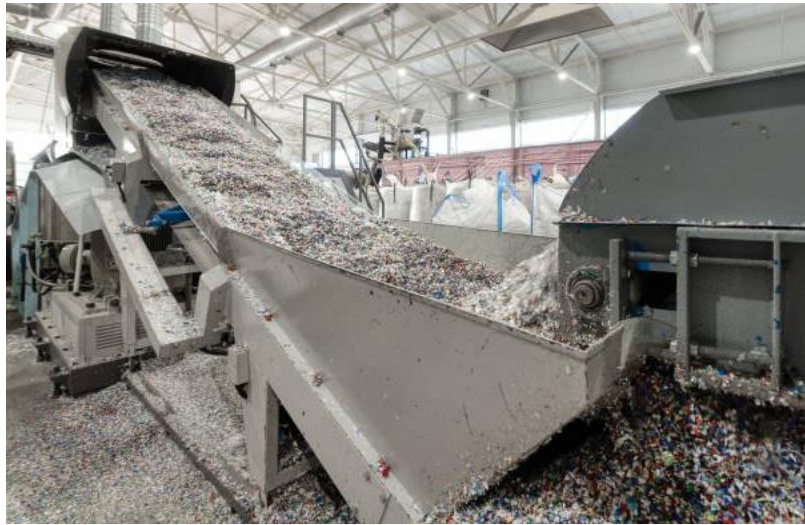
Abbildung 12; Maschine die PET zerkleinert
