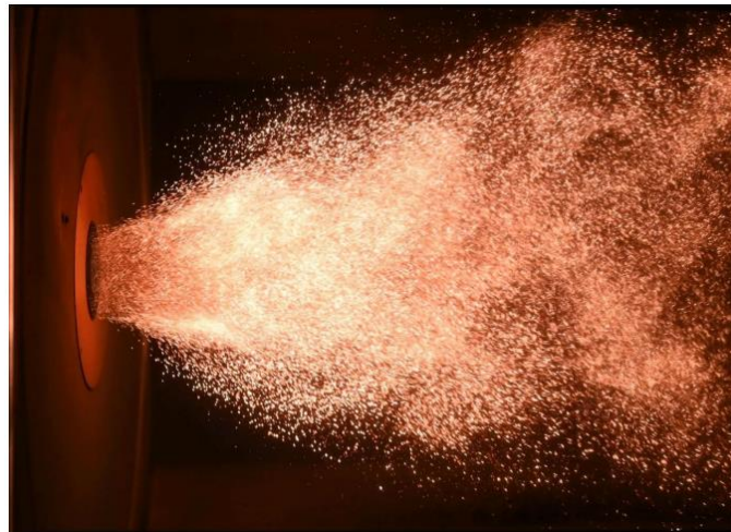
Abbildung 7.5, Eisenstaub Verbrennung von: Präsentation von Clean Circles "IRON IS THE NEW COAL"
