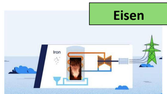
Abbildung 7.15, Eisen-Befeuerung von Clean Circles, Präsentation: Iron is the new Coal
