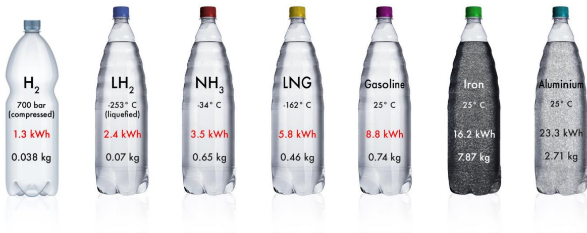
Abbildung 7.1, Energiedichte mittels PET-Flaschen von: Präsentation von Clean Circles "IRON IS THE NEW COAL"
