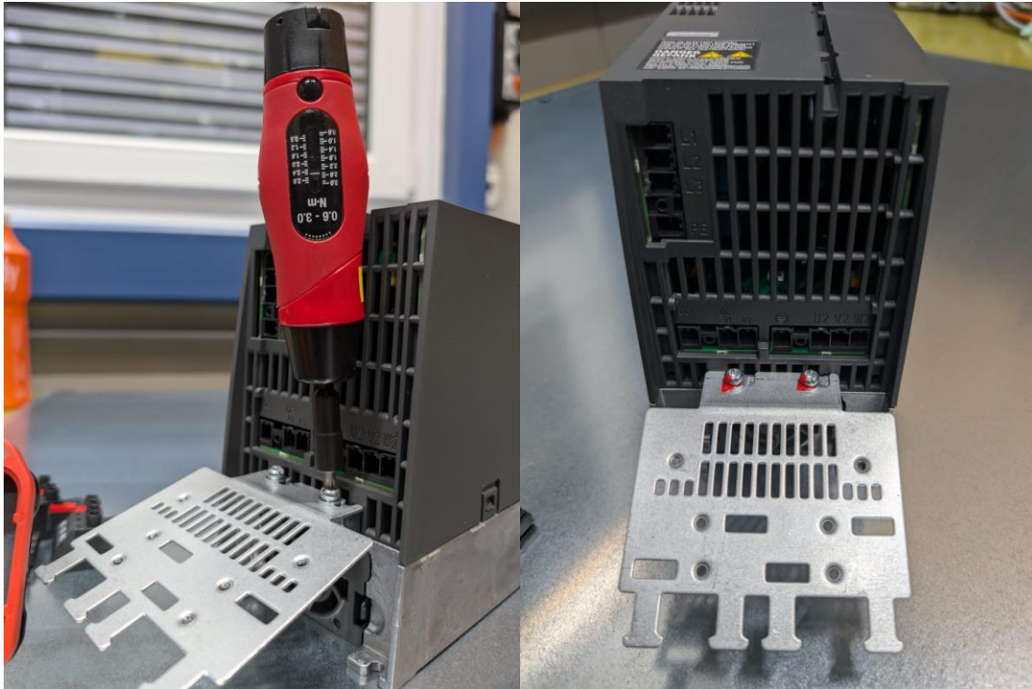
Abbildung 19: Montage und Siegelung Schirmblech
