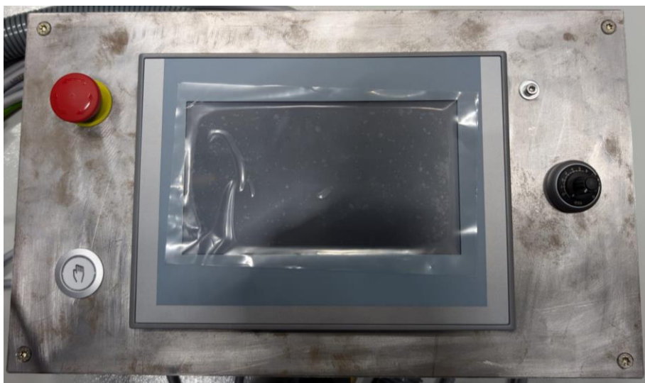
Abbildung 20: Flugrostbildung an Panelhalterung
