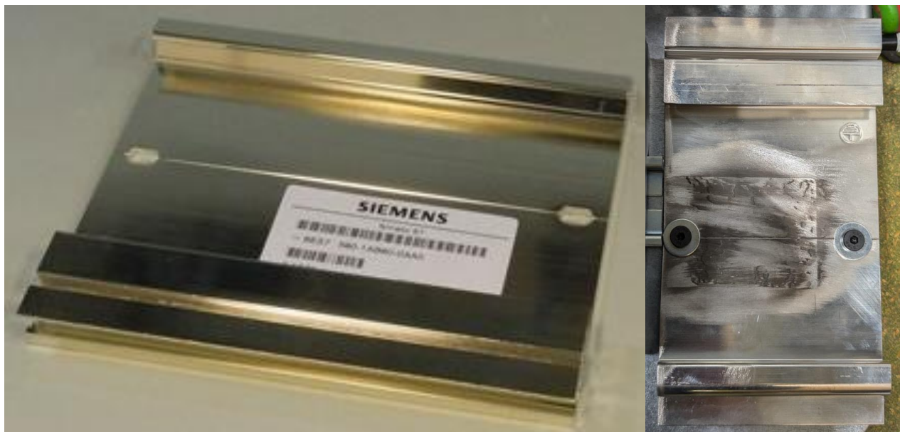
Abbildung 14: Profilschiene CPU im Vergleich (l. Original; r. gekürzt)
