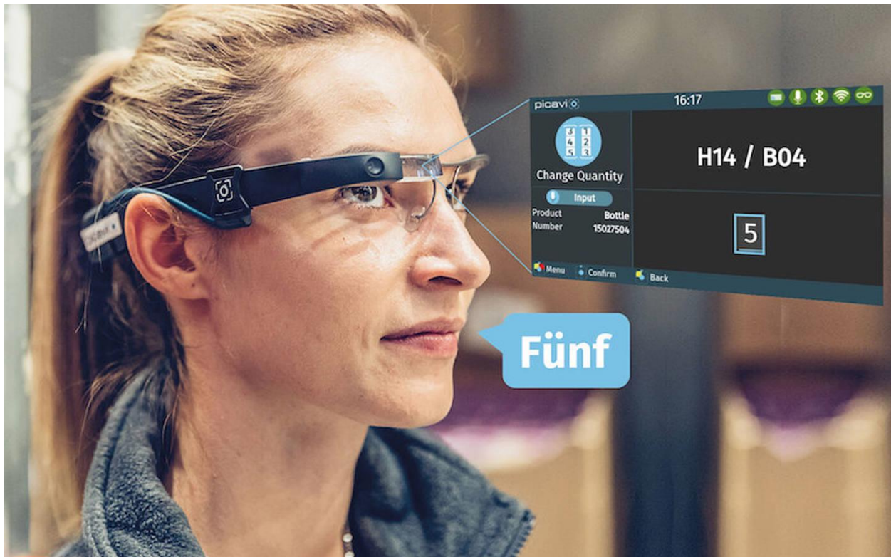
Abb. 21 Mit einer Sprachsteuerung sorgt die AR-Brille für mehr Flexibilität bei der Bedienung seiner Pick-by-Vision-Lösung 28
