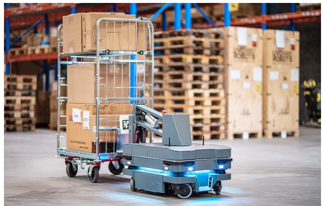
Abb. 27 MIR kann einen Handkarren erfassen und autonom durch Ihre Anlage bewegen 53
