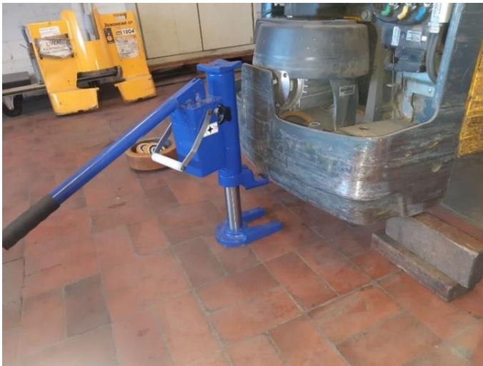
Eigenes Foto: Fahrzeug wird mit Wagenheber aufgebockt und mit Holzklötz gesichert
