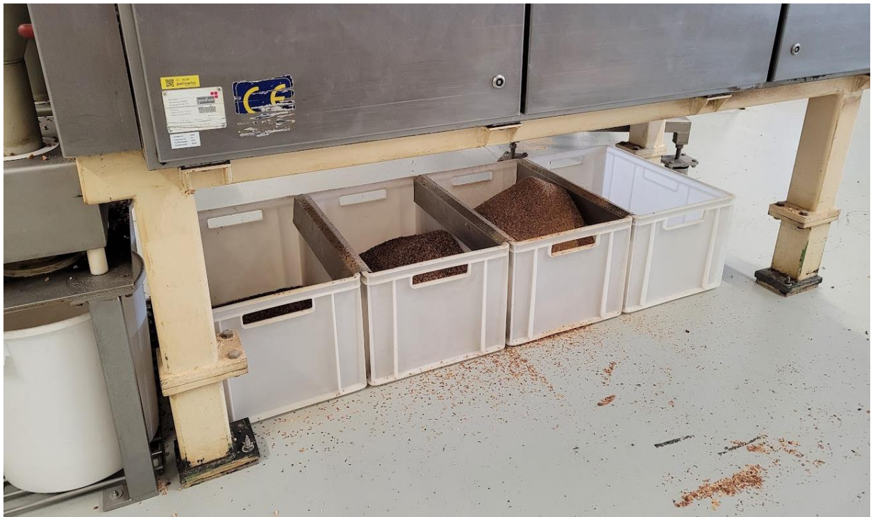
Abbildung 6-3 Sammlung des Feianteils in Gebinden unter dem Ausgang an der Siebanlage
