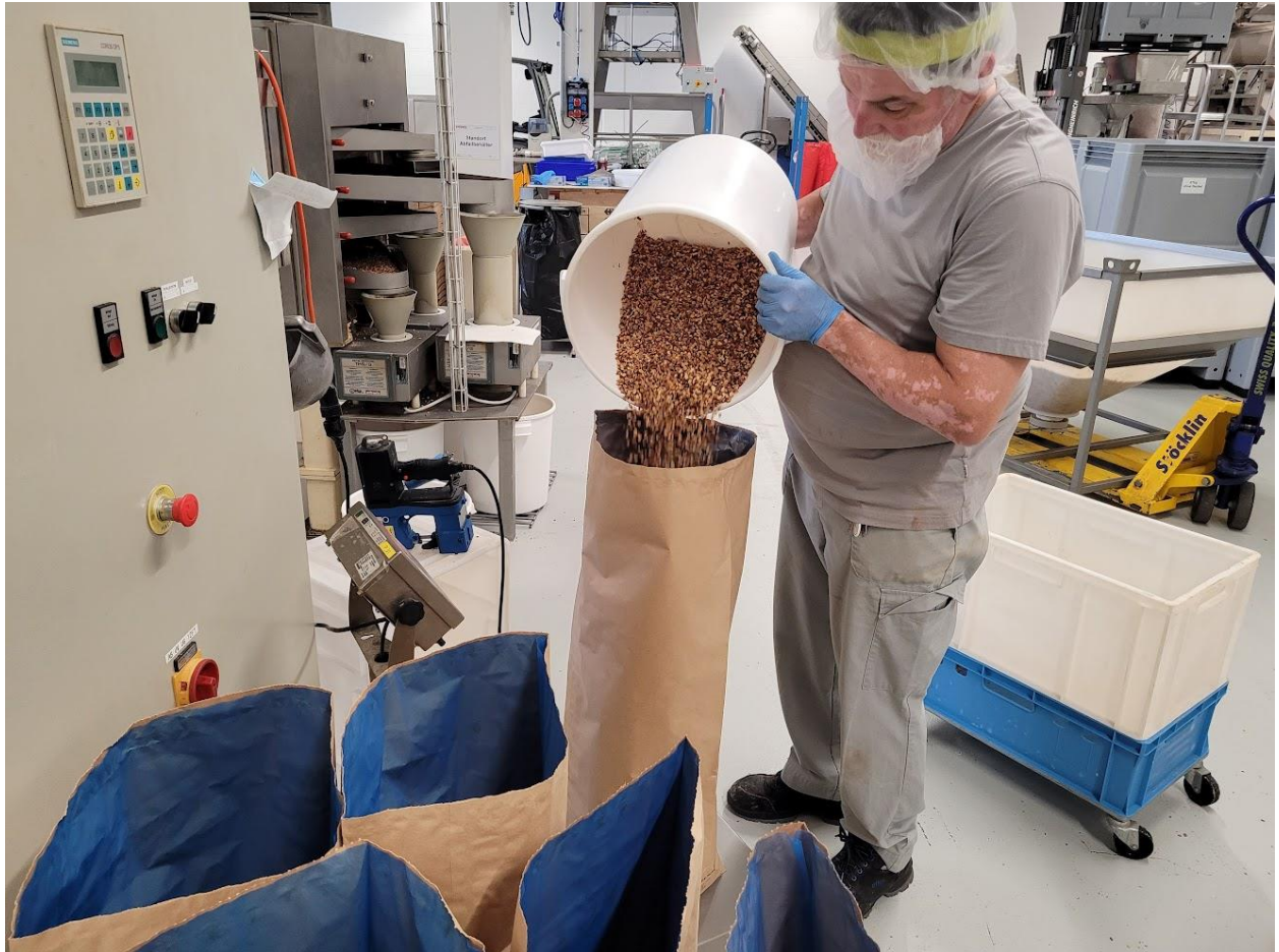
Abbildung 6-2 Mitarbeiter bei der manuellen Umverteilung der Granulatstufen in Papiersäcke
