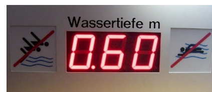
Abbildung 41: Digitale Anzeige Wassertiefe
