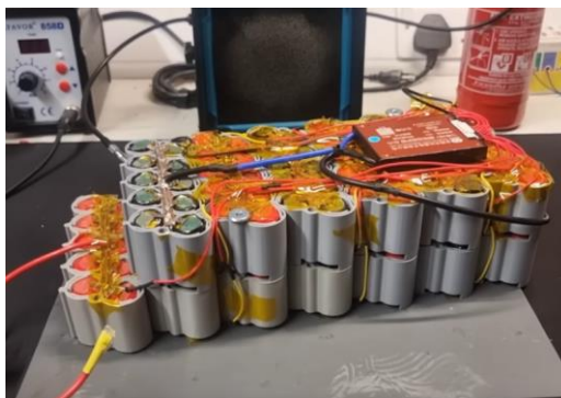
Abbildung 27 Beispiel eines selbstgemachten E-Bike-Akkus
