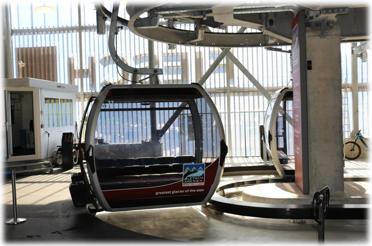
Abbildung 16 CWA Omega V in der Talstation
