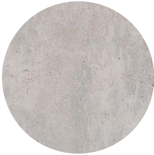
Wände Typ 4; Sichtbetonoberfläche mit Tafelstruktur
