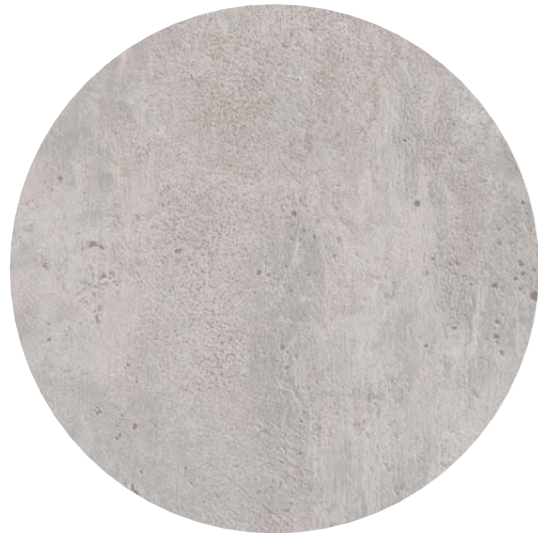
Wände Typ 4; Sichtbetonoberfläche mit Tafelstruktur
