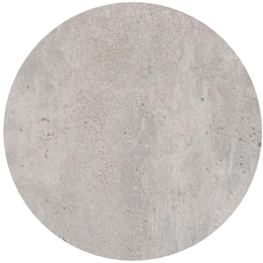
Wände Typ 4; Sichtbetonoberfläche mit Tafelstruktur
