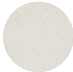
Wände: Abrieb 0.7mm, NCS ...
