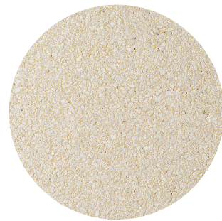
Fassade: Betonelemente sandgestrahlt mit Jura-Kalkstein
