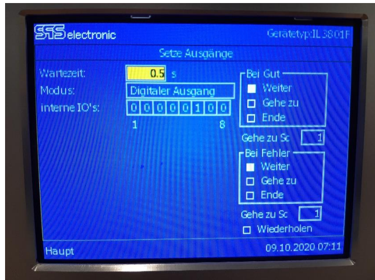
Abbildung 26 IL3800 Ausgänge setzen
