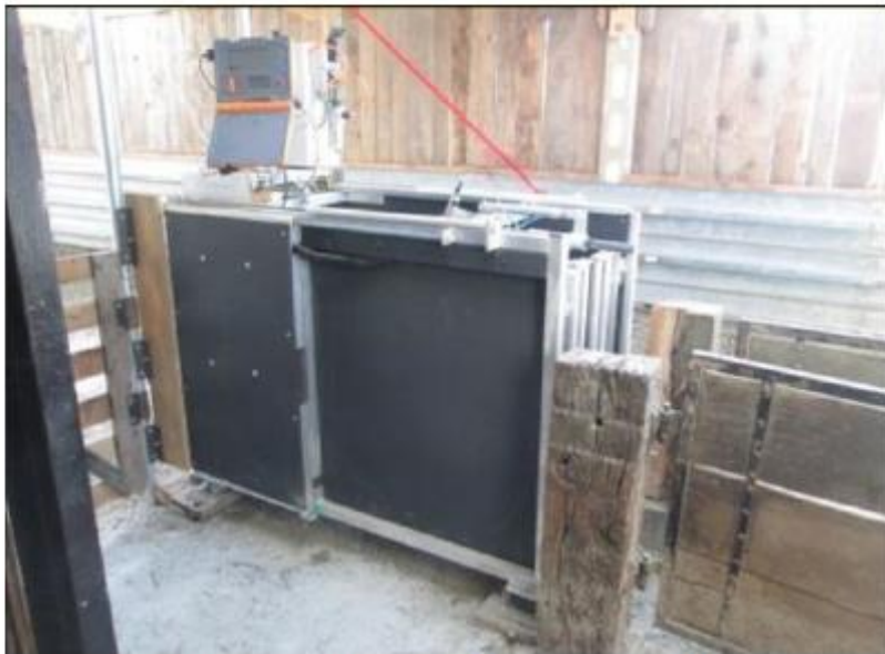
VENO Drafter: Automatisches Wiege- und Sortiersystem für Schafe
