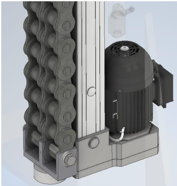
Abbildung 31: Kettenanker am Zug-Druckkraftsensor
