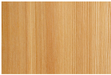
Lärchenholz Geländer, Stützen, Ja- lousienläden, Einfassun- gen, Handlauf und dgl.
