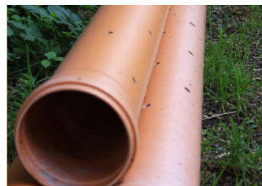
Sickerrohr Untergeschoss Neubau und Umbau
