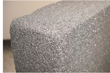
Schaumglas Dämmung Unterge- schoss Wände
