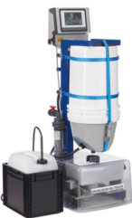
Dosiergerät für Calciumhypochlorit-Granulat und Säure für die Desinfektion und pH-Regelung von Schwimmbadwasser. Chlordosierung direkt aus dem Lieferfass, Säure aus dem Chlorfass. Chlorgranulat und Säure werden abwechselnd mit Zwischenpausen in die Löseeinrichtung dosiert. Die dosierten Chemikalien werden vollständig gelöst, über ein Injektorsystem abgesaugt und als unterchlorige Säure dem Schwimmbadwasser zugeführt. Dosierung kontinuierlich oder über externe Regler gesteuert. Alle Funktionen werden ständig überwacht. Optionale Funktion: Parallel zur Chlorversorgung des Hauptbeckens kann ein Puffertank mit Chlorklösung mit einstellbarer Konzentration befüllt werden, um weitere Becken mit Chlorklösung über Dosierpumpen zu versorgen - GRANUDOS 45/100-Touch-PB.
