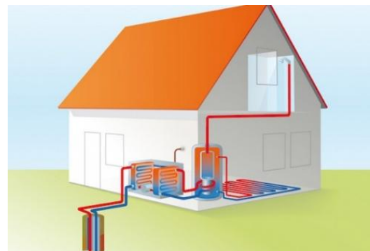
Abbildung 46: Funktionsprinzip Sole/Wasser Wärmepumpe
