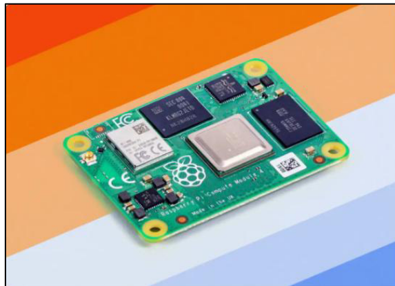
Abbildung 6 CM4 (nach Raspberry Pi CM4 2012)
