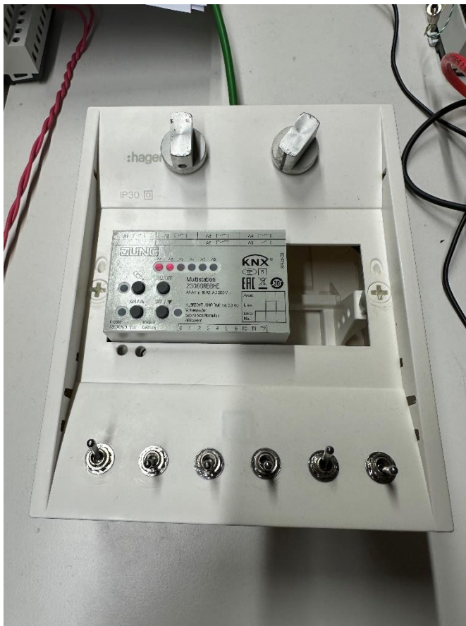
Abbildung 58: Testbox mit KNX-Modul
