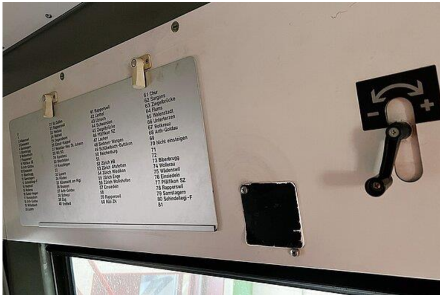
Abbildung 6: Kurbel zur Bedienung der Rollbandanzeige
