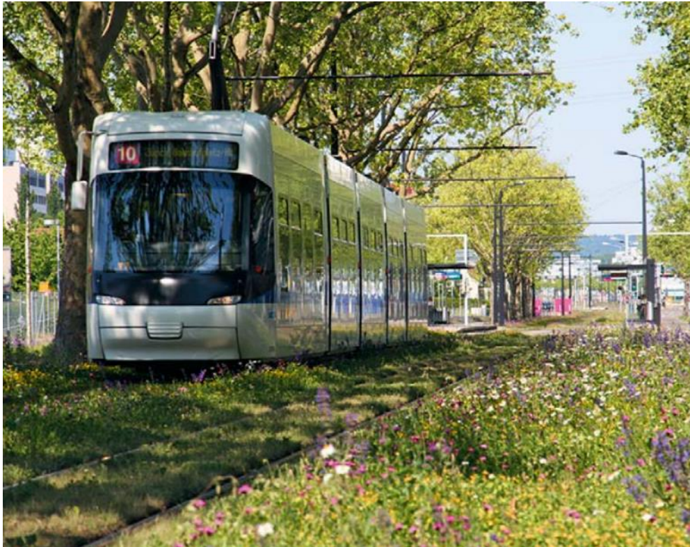
Abbildung 25: Ein begrüntes und beschattetes Gleistrasse der Glattalbahn.
