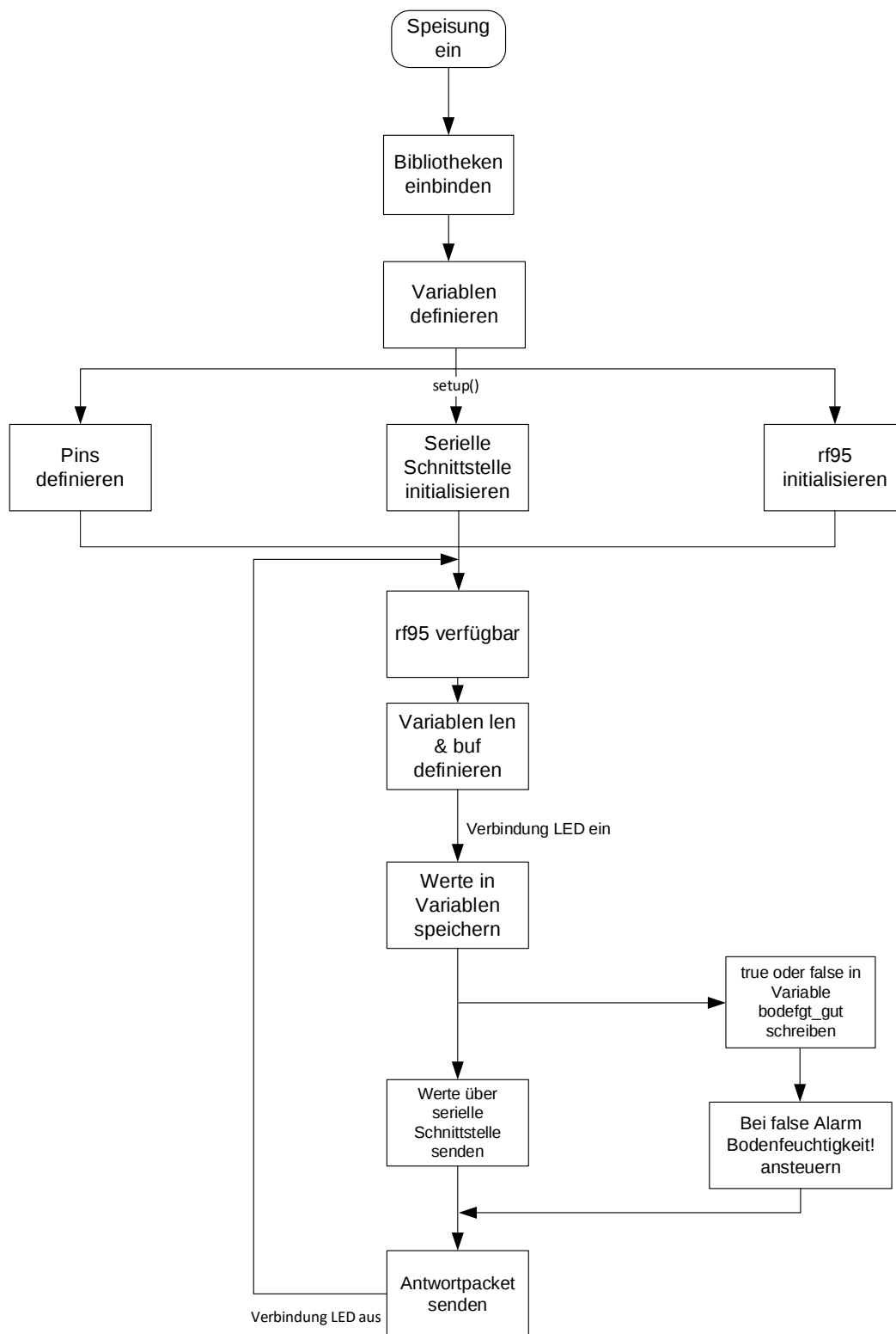
Abbildung 5-35 Flussdiagramm Software Empfänger
