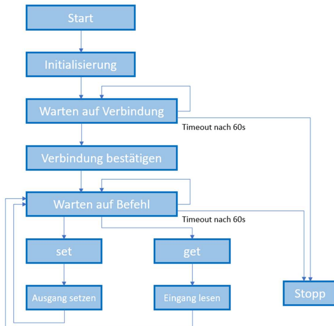
Abbildung 54 Blockdiagramm Schnittstellen zu Test-Infrastruktur
