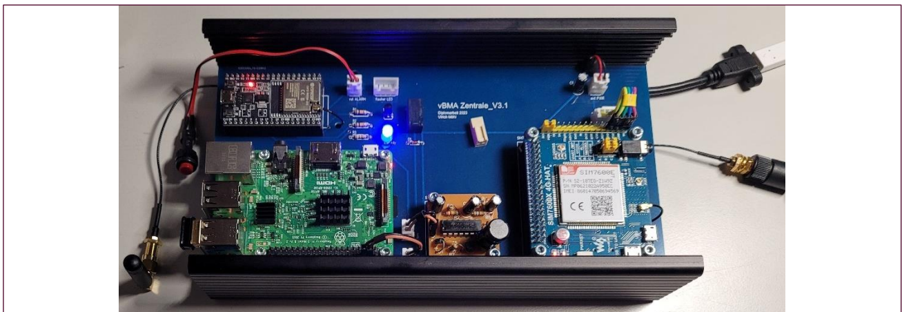
Abbildung 54: vBMA Zentrale im Testbetrieb mit externen Antennen
