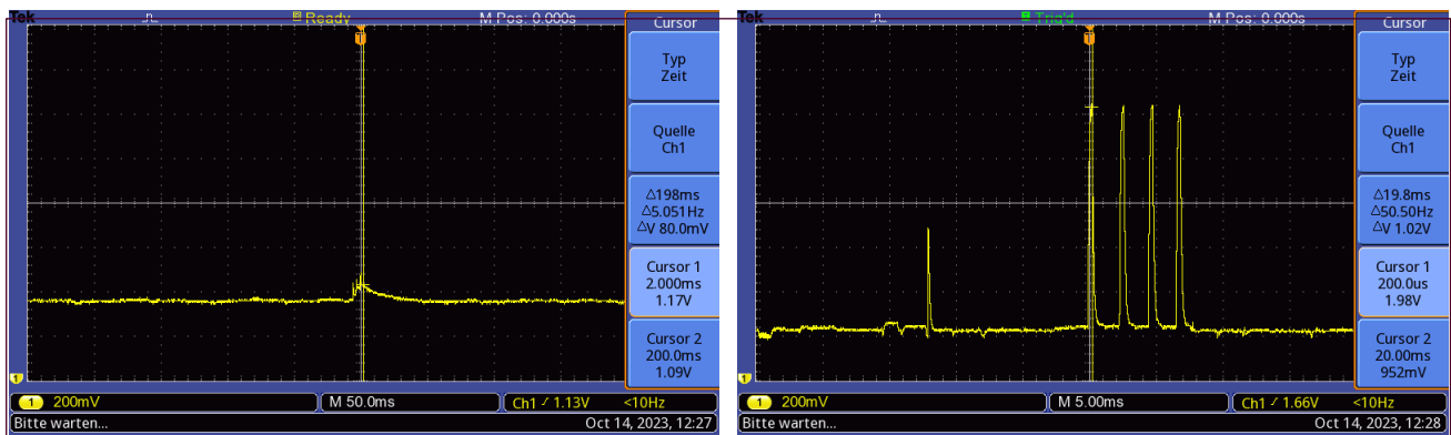
Abbildung 24: impulsförmige Stromspitzen mit und ohne C2
