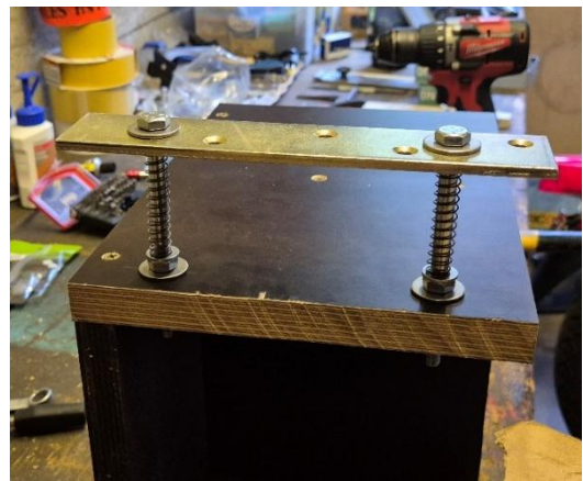
Abbildung 3-2 Vorrichtung zur Schnappschalterbetätigung
