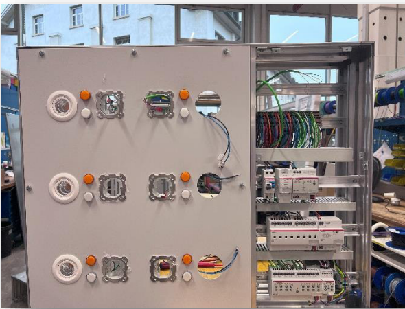
Abbildung 8 Montage der Befestigungsplatten und der LED-Spots
