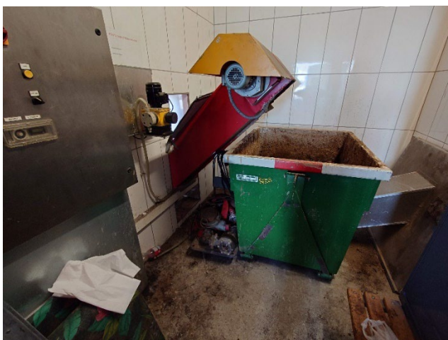
Abbildung 8: Auswurf vom Kratzförderer in einen Container
