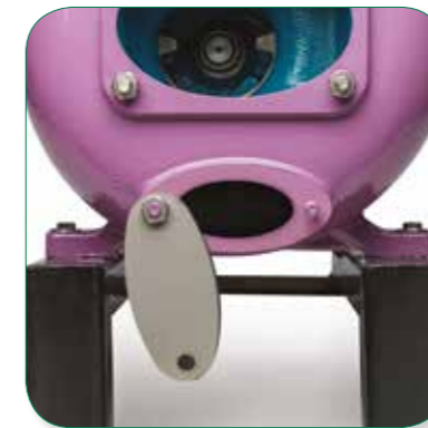
Ablassdeckel für die Entleerung des Gehäuses. Notwendig für die kalte Jahreszeit, um bei Stillstand ein Gefrieren des Mediums zu vermeiden.
