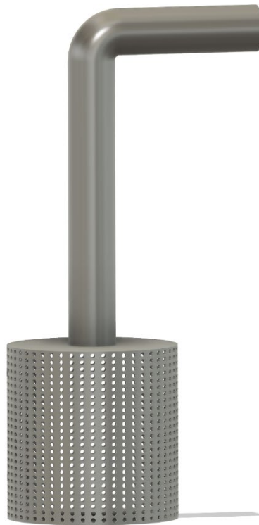
Abbildung 27: Beispiel-Zeichnung für einen Ansaugfilter
