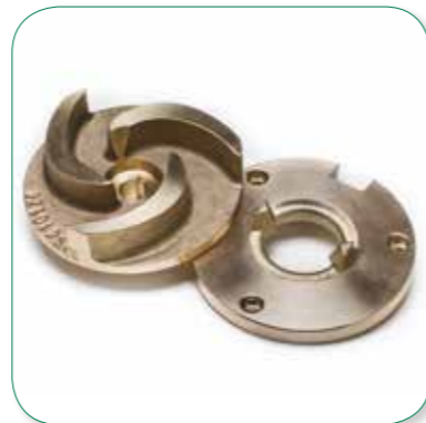
Laufrad und Verschleißplatte mit Schneidwerk AUF ANFRAGE: um weiche Festkörper und Filamente zu zerkleinern. Optimal für Abwasser mit Gemüseresten oder Etiketten.
