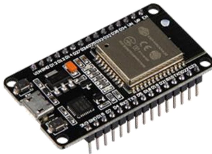
Abbildung 5: Bild des NodeMCU ESP32 WiFi- und Bluetooth-Moduls
