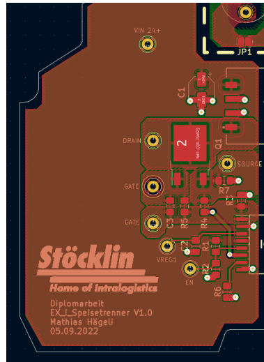
Abbildung 6.3: Nicht eigensicher Stromkreis
